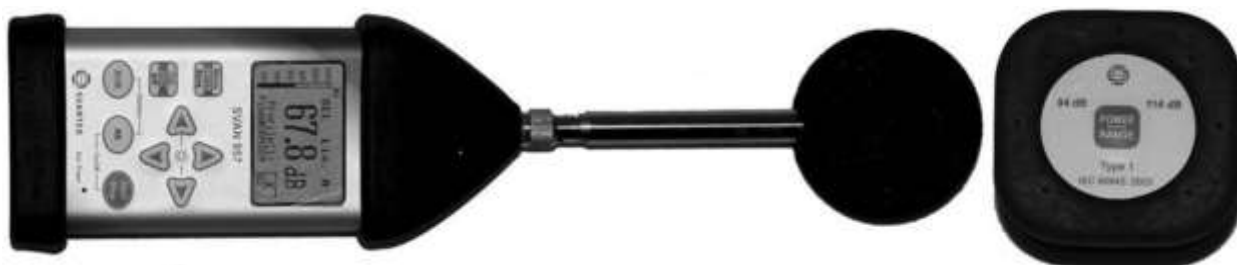
18 pav. SVAN 957 Triukšmo ir vibracijos matuoklis.
